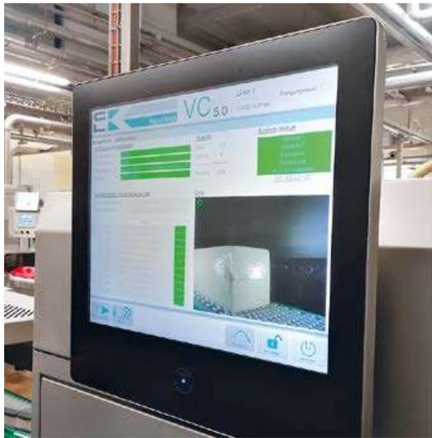
*Auf einem Kontrollscreen direkt in der Produktion können sich die Mitarbeiter den Prüfstatus der Reifungsbeutel anzeigen lassen (Foto: Molkerei Ammerland)*
